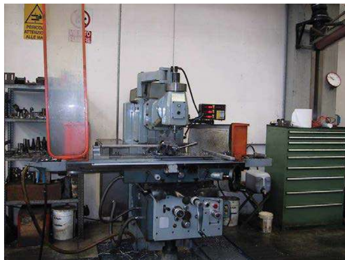
Figura 13 – Macchina con riparo mobile aperto
