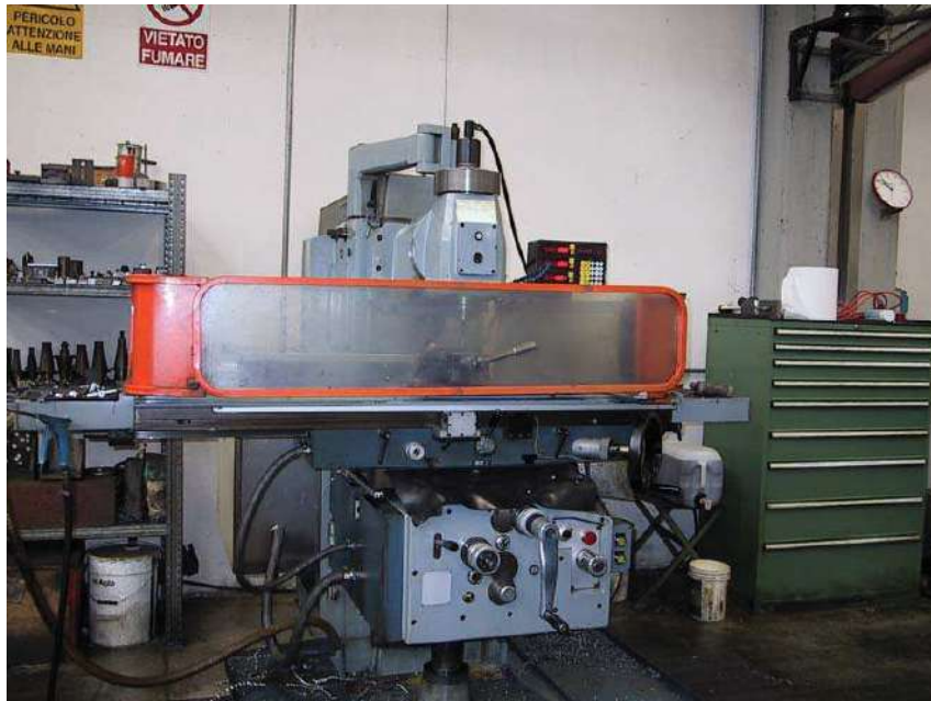
Figura 12 – Fresatrice dotata di riparo mobile con dispositivo di blocco
