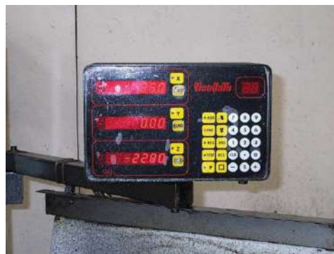
Figura 15 – Quadro di comando della fresatrice (notare i comandi per il moto del pezzo nelle tre direzioni X, Y e Z)
