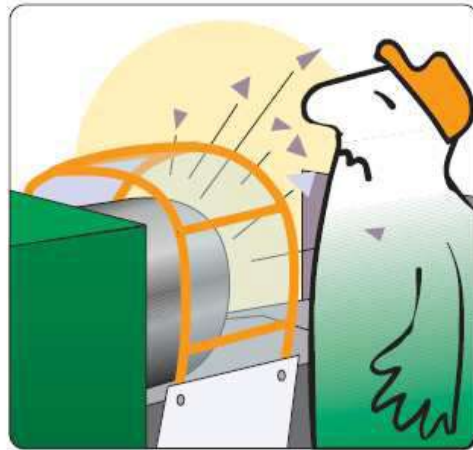
Proiezione del materiale in lavorazione per effetto della forza centrifuga.
