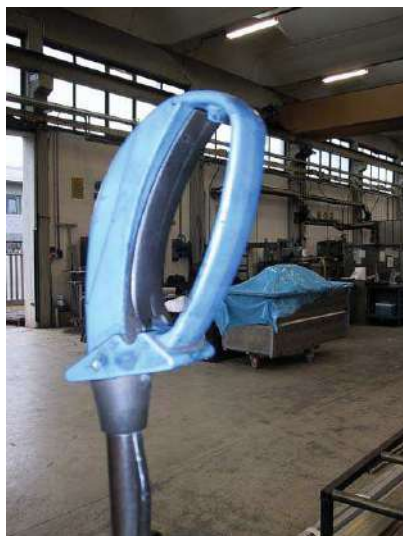
Figura 10 – Interruttore a pressione continua posto sull'impugnatura
