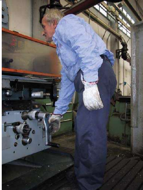
Figura 14 – Inserimento della frizione per la messa in rotazione del mandrino
